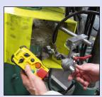
Control de máquina paso a paso mediante el mando de parada de emergencia inalámbrico o mando de validación inalámbrico.
